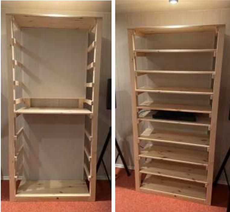
Nur das oberste, das unterste und das mittlere Board sind fixiert. Alle anderen sind nur eingelegt. Die Lücke zwischen beiden Absorptionsmodulen habe ich bewusst gelassen, da meine Endstufe relativ tief baut und diese dort platziert wurde. Hier noch ein paar Detailaufnahmen:
