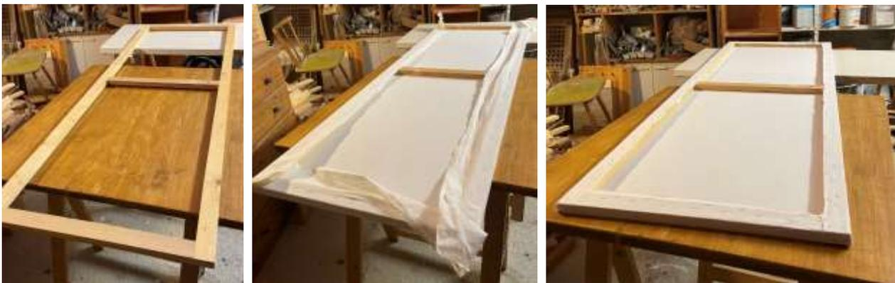
Zuerst einen rechteckigen Rahmen aus Dachlatten bauen. Größe außen: 190 x 65 cm (wenn du die Module für einen höheren Raum baust, Maße entsprechend ändern) Ich habe die Enden mit einer 90° Winkelklemme zusammengehalten, die überstehenden Latten 2x vorgebohrt (!) und die Ecke mit zwei Stück 4,0 x 70 Spax-Schrauben zusammengeschraubt. Zur Stabilisierung ein bis zwei Querstreben mittig einziehen.
